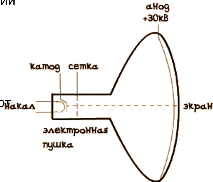
Подавая на сетку отрицательное напряжение (относительно катода), можно ослабить интенсивность потока электронов в луче, или вообще закрыть "дорогу" для электронов. Это бывает нужно, например, при перемещении луча от конца одной строки к началу другой.
