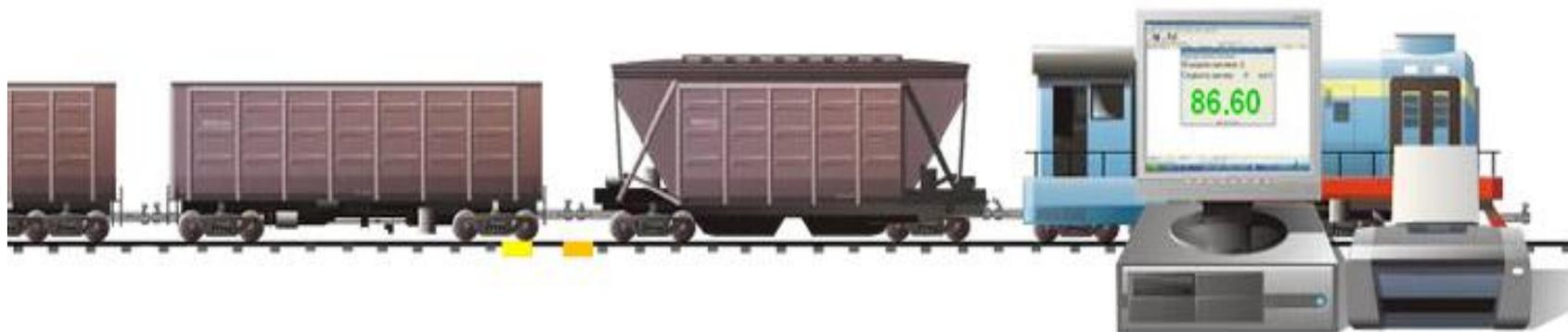
*Вагонные весы предназначены* для взвешивания подвижного состава в статическом режиме и в динамическом при движении без расцепки вагонов, в режиме дозирования, загрузки или разгрузки материалов
