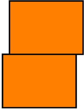
В результате пластического деформирования одна часть кристалла смещается относительно другой
