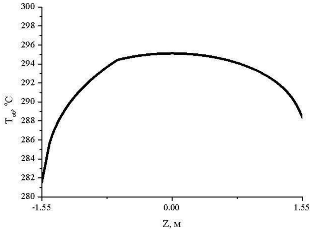
В центре топлива достигается максимальная температура в реакторе. Термическое сопротивление между центром топливной таблетки и внешней границей оболочки твэл составляют: сама оболочка, газовый зазор и топливная таблетка.
