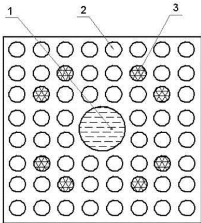
1. Центральный канал с некипящим замедлителем. 2. тепловыделяющий элемент. 3. Направляющая труба.
