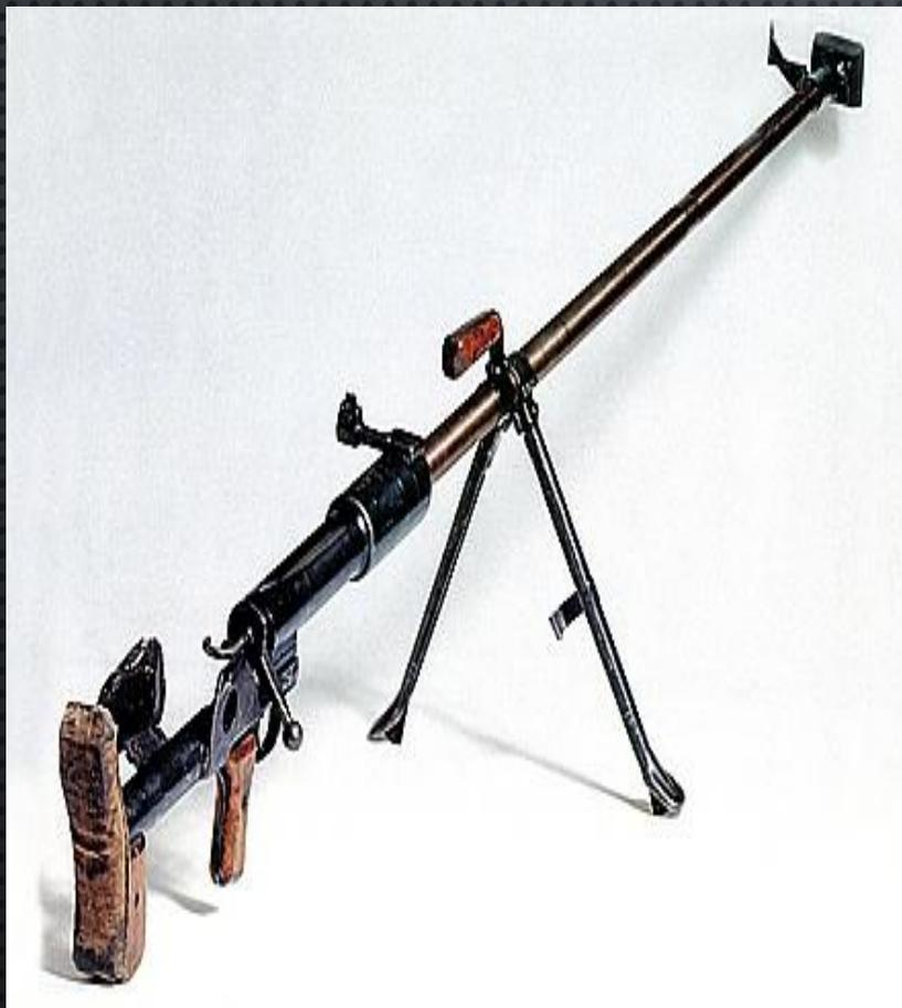
Противотанковое однозарядное ружьё обр. 1941 г. системы Дегтярева (ПТРД) — советское противотанковое ружьё (фактически, винтовка, поскольку имеет нарезной ствол) системы Дегтярева, принятое на вооружение 29 августа 1941 года. Предназначалось для борьбы со средними и лёгкими танками и бронемашинами на расстояниях до 500 м. Также из ружья мог вестись огонь по ДОТам/ДЗОТам и огневым точкам, прикрытым броней, на расстояниях до 800 м и по самолётам на расстояниях до 500 м.
