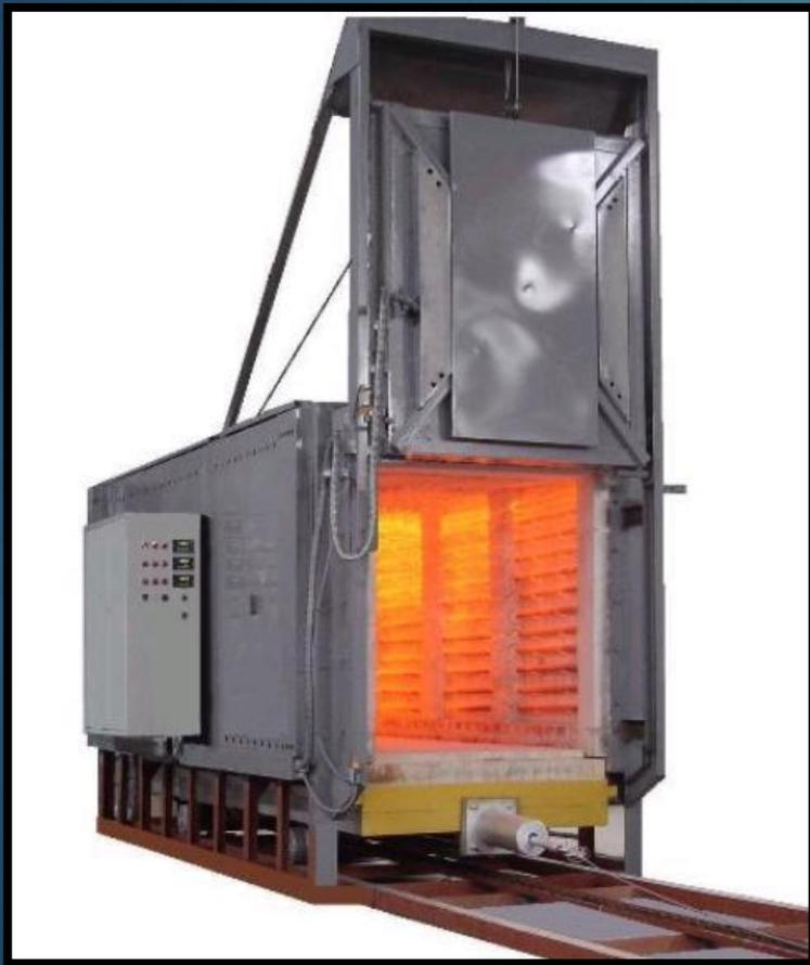
Камерная печь – это печь, используемая для нагрева или термообработки материалов различного рода. Конструктивно она устроена так, что параметры длины, ширины и высоты близки по значению. Температура во всех точках рабочего пространства одинакова.
