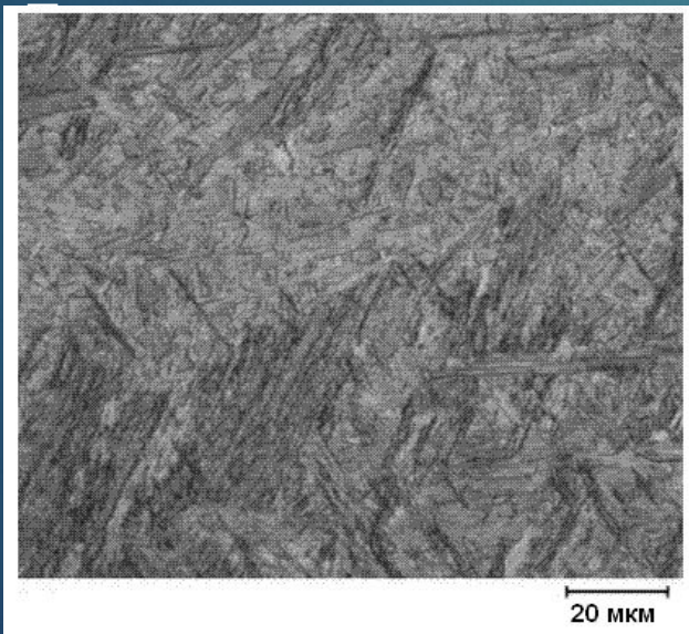
Оптическая микрофотография реечной структуры мартенсита в стали с 0,18 % углерода
