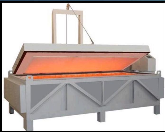
Печи-ванны применяются для нагрева под закалку, отпуск, нормализацию, химико-термическую обработку и для охлаждения при ступенчатой и изотермической закалке.
