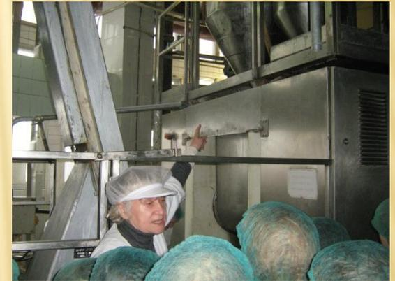
СНАЧАЛА МУКА ИДЕТ ПО ТРУБАМ И ПОПАДАЕТ В ОГРОМНОЕ СИТО, ГДЕ ОЧИЩАЕТСЯ ОТ ПРИМЕСЕЙ. В СИТЕ УСТАНОВЛЕННЫ МАГНИТЫ. ПОСЛЕ ПРОСЕИВАНИЯ МУКА ПО ТРУБАМ ИДЕТ В БОЛЬШОЙ МИКСЕР, ГДЕ ОНА ПРЕВРАЩАЕТСЯ В ТЕСТО.
