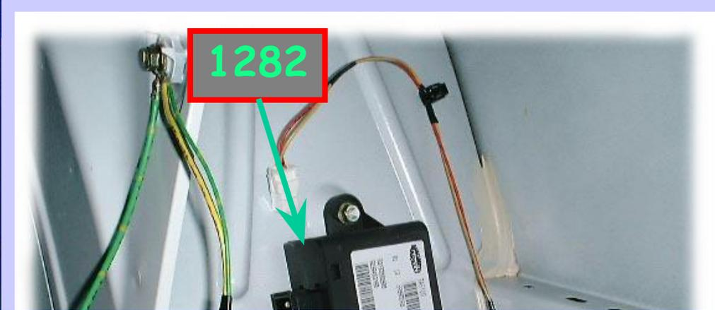
Компьютер системы ввода присадки получает информацию о каждом заполнении топливного бака (независимо от того, работает ли двигатель).
