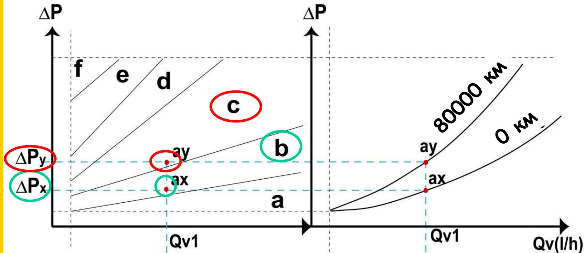
Как можно видеть на графиках, при постоянном расходе газа ( $Q_{v1}$ ), количество церина, аккумулированного в фильтре, изменяет значение разности давлений на постоянную величину, не зависящую от количества частиц загрязнений.
