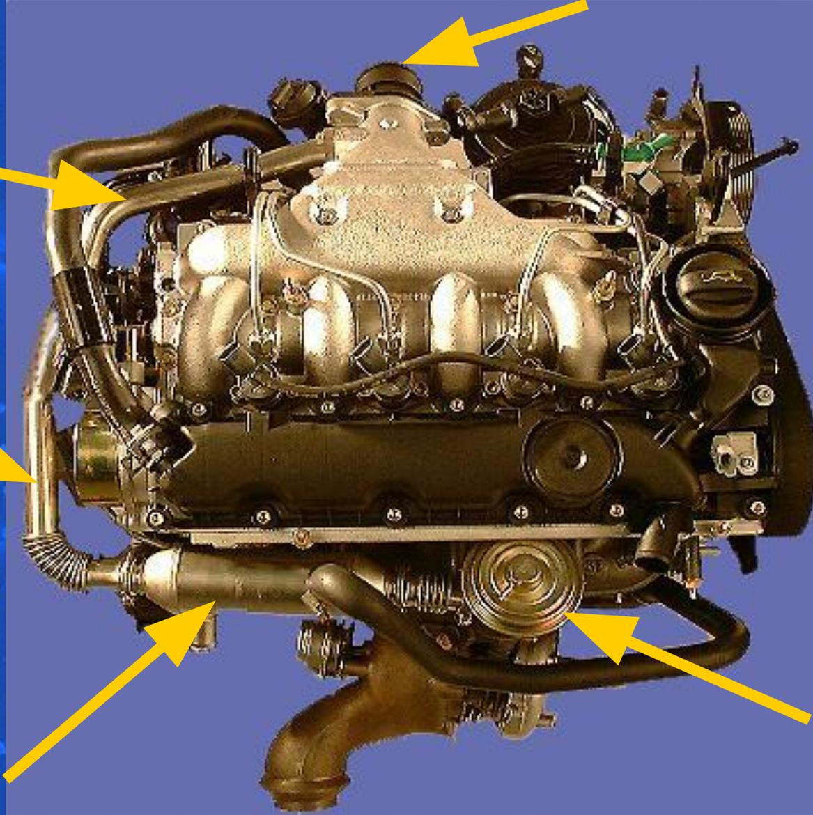
Как и для двигателя DW10, система рециркуляции отработавших газов EGR работает по замкнутому циклу в режиме, который зависит от расхода воздуха, поступающего в двигатель.
