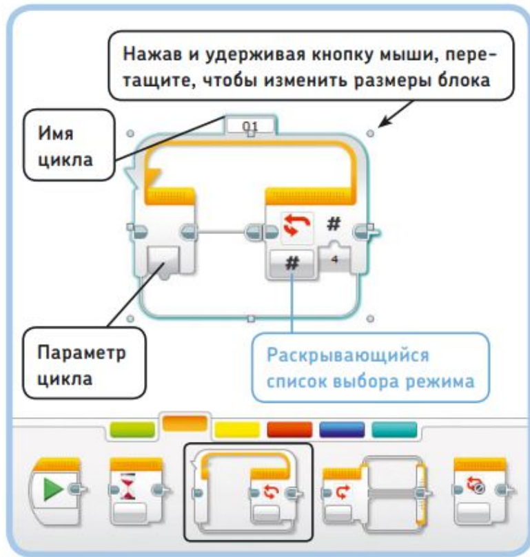
Рис. 5.4. Блок Цикл в режиме Подсчет . В данной конфигурации программа будет запускать любые блоки, размещенные в пределах этого цикла, четыре раза. В других режимах блоки, расположенные внутри цикла, могут повторяться в течение указанного количества секунд или неограниченного времени
