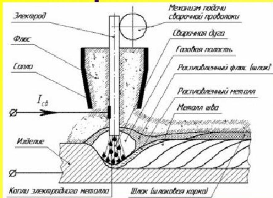
При этом способе сварки электрическая дуга горит под зернистым сыпучим материалом, называемым сварочным флюсом.
