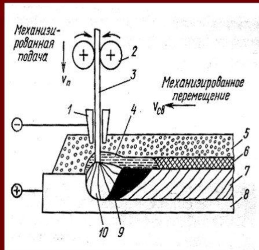
1 – токоподвод, 2 – подающие ролики, 3 – электродная проволока, 4 – слой жидкого шлака, 5 – слой флюса, 6 – шлаковая корка, 7 – наплавленный слой, 8 – деталь, 9 – жидкая сварочная ванна, 10 – дуга
