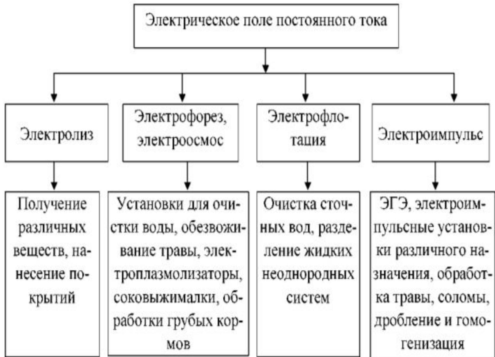
Рисунок 4 - Электротехнологические процессы с применением электрического поля постоянного тока
