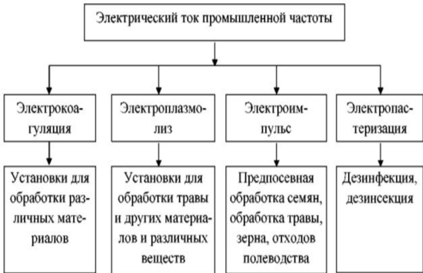
Рисунок 6 - Электротехнологические процессы при использовании тока промышленной частоты
