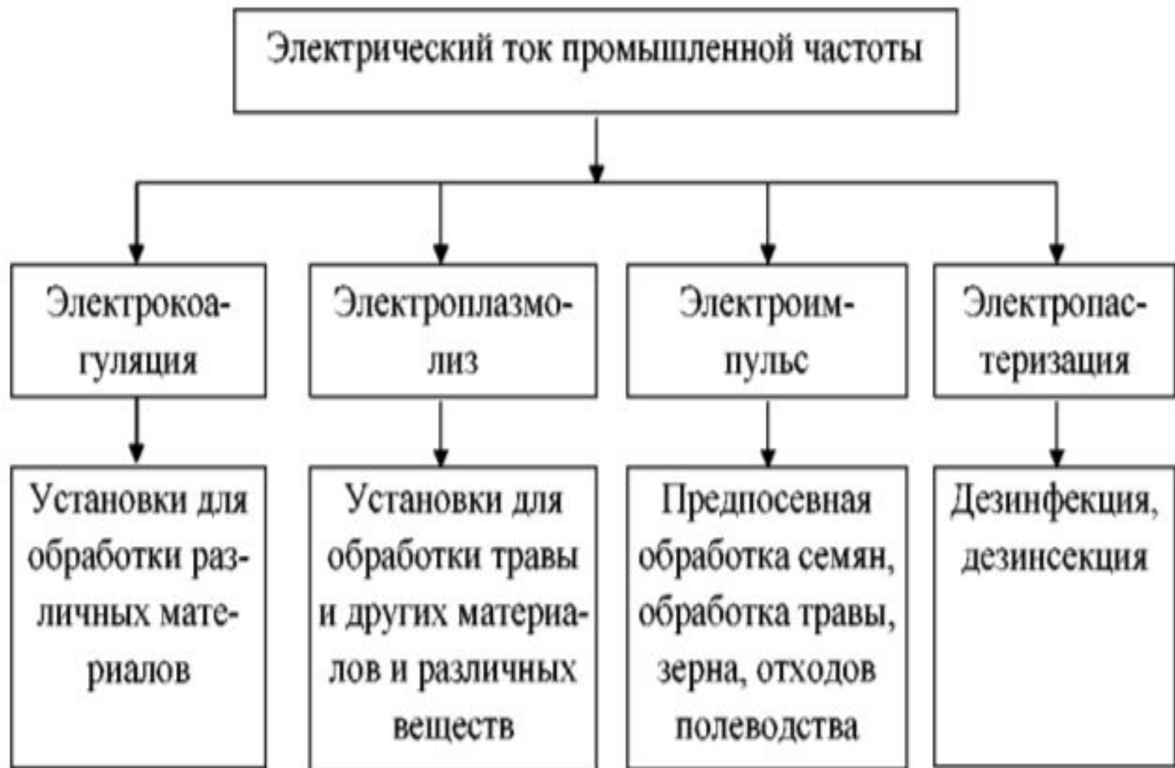
Рисунок 6 - Электротехнологические процессы при использовании тока промышленной частоты
