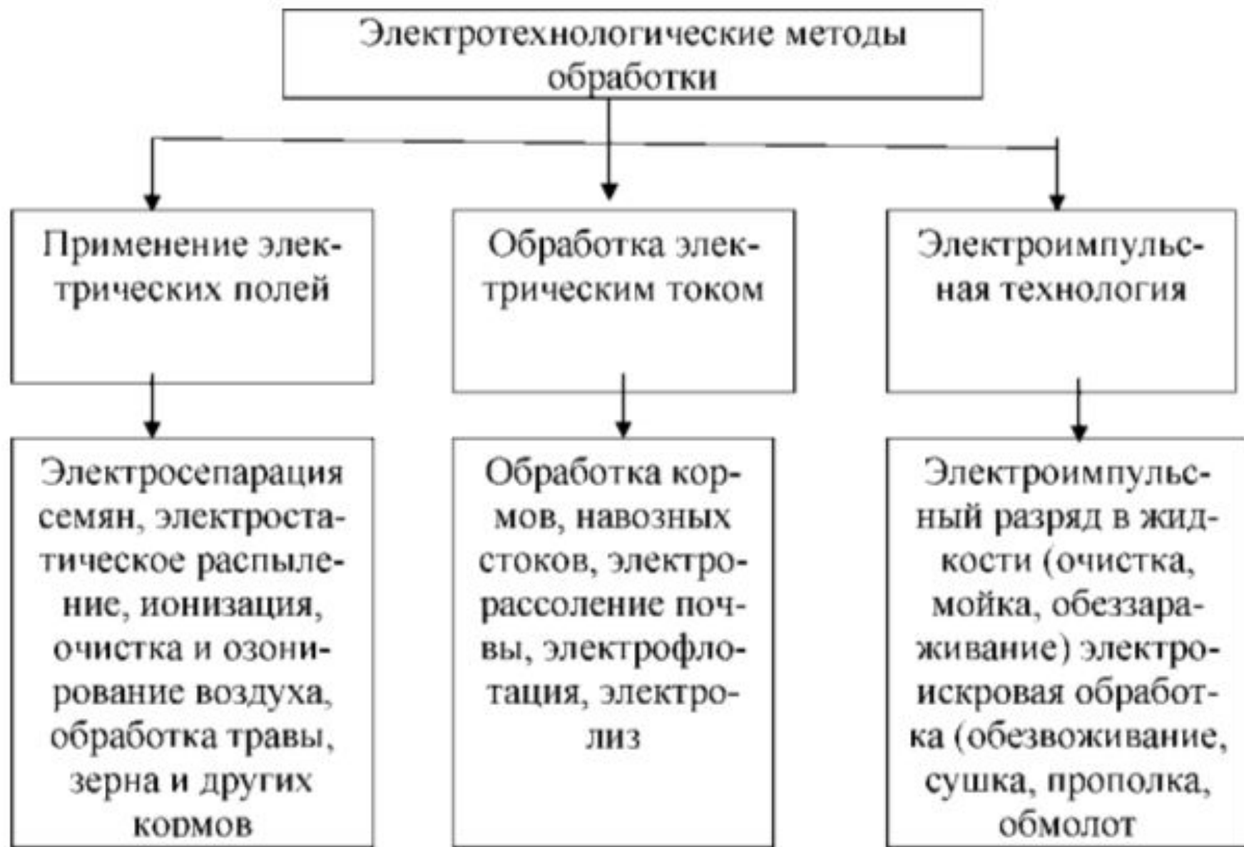
Рисунок 2 - Классификация электротехнологических методов обработки по характеру используемой электрической энергии
