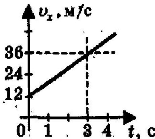
Пользуясь графиком зависимости проекции скорости автобуса от времени  $v_x(t)$ , определите модуль перемещения автобуса за 4 с.
