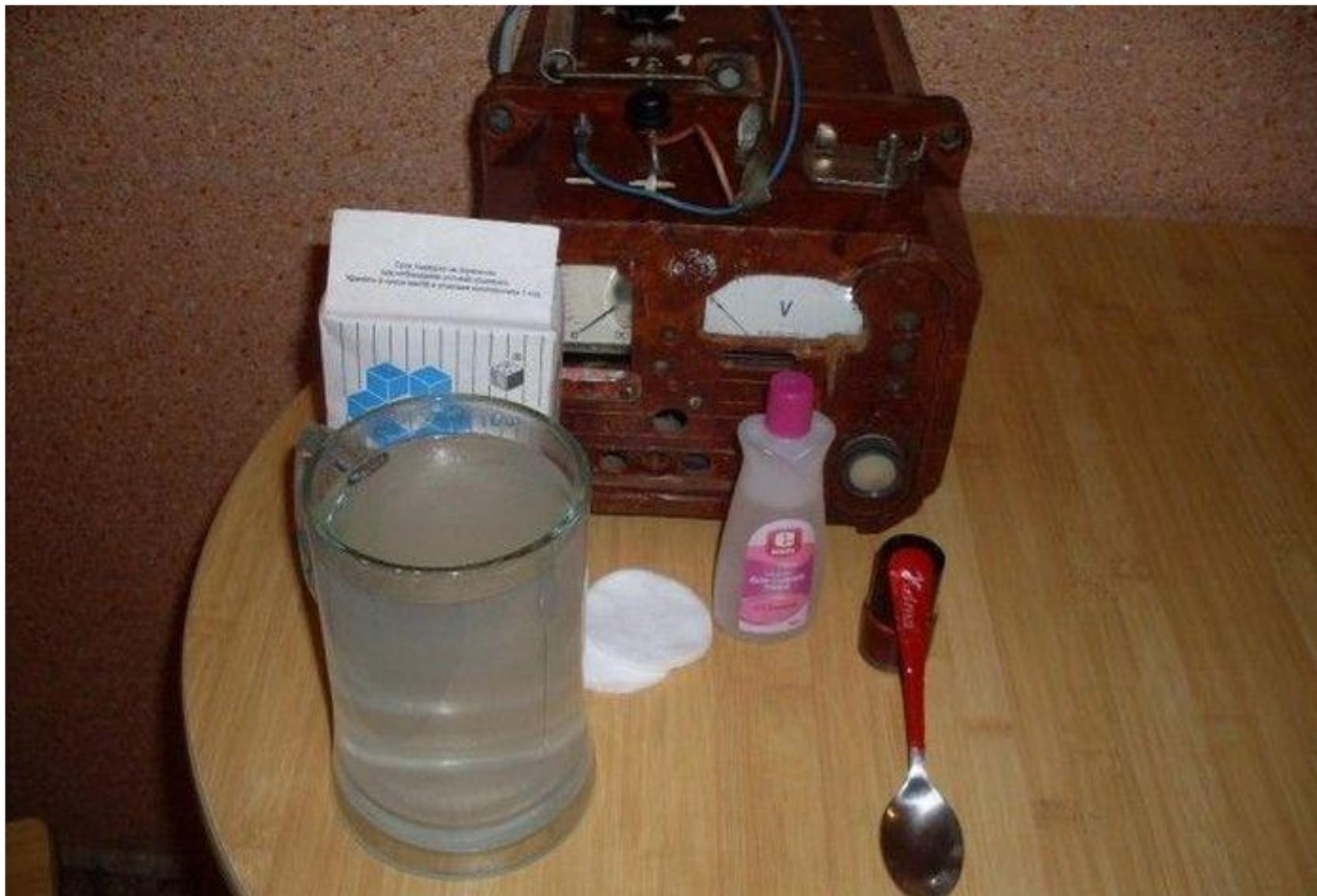
**Заливаем в неметаллический сосуд воду и размешиваем соль.**
