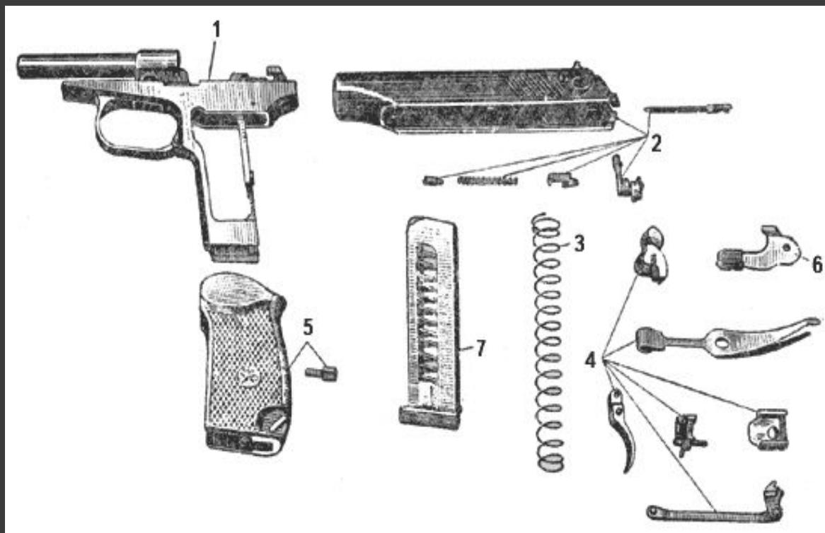
1 - рамка со стволом и спусковой скобой; 2 - затвор с ударником, выбрасывателем и предохранителем; 3 - возвратная пружина; 4 - части ударно-спускового механизма; 5 - щечки рукоятки с винтом; 6 - затворная задержка; 7 - магазин
