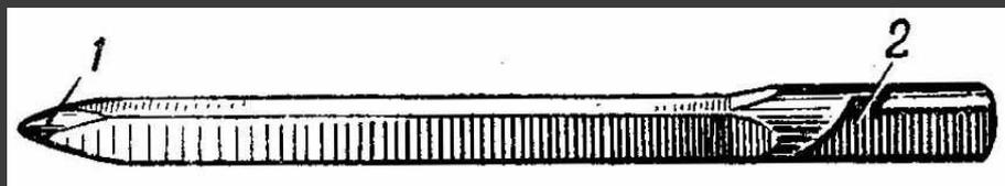
1 - боек; 2 - срез для предохранителя
