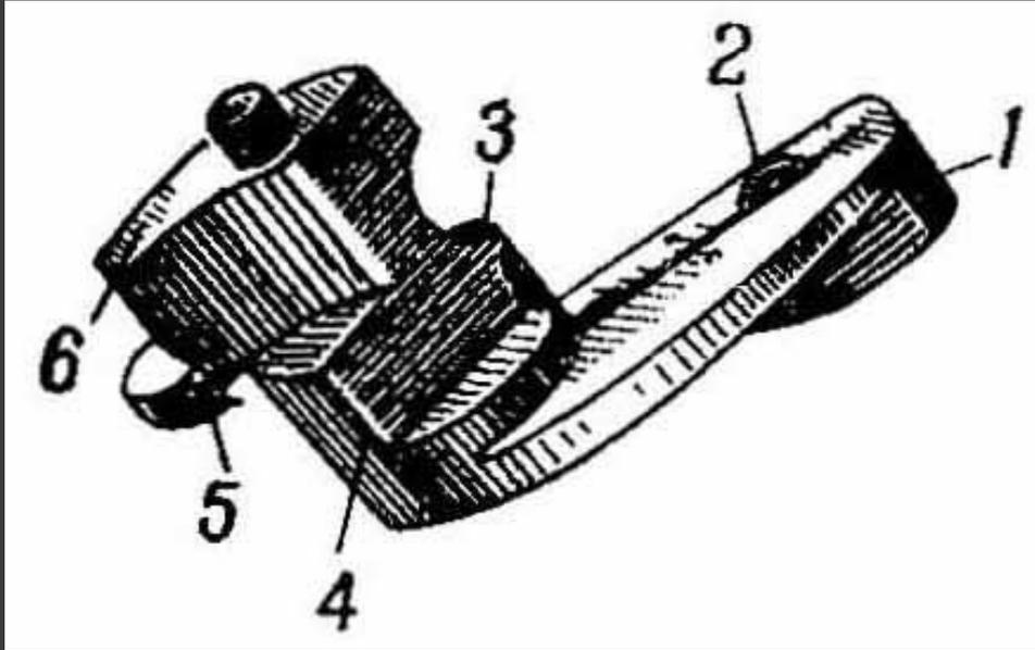
1 - флажок предохранителя; 2 - фиксатор; 3 - уступ; 4 - ребро; 5 - зацеп; 6 - выступ
