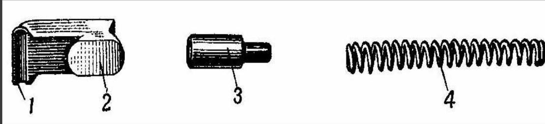
1 - зацеп; 2- пяточка для соединения с затвором; 3 - гнеток; 4 - пружина выбрасывателя
