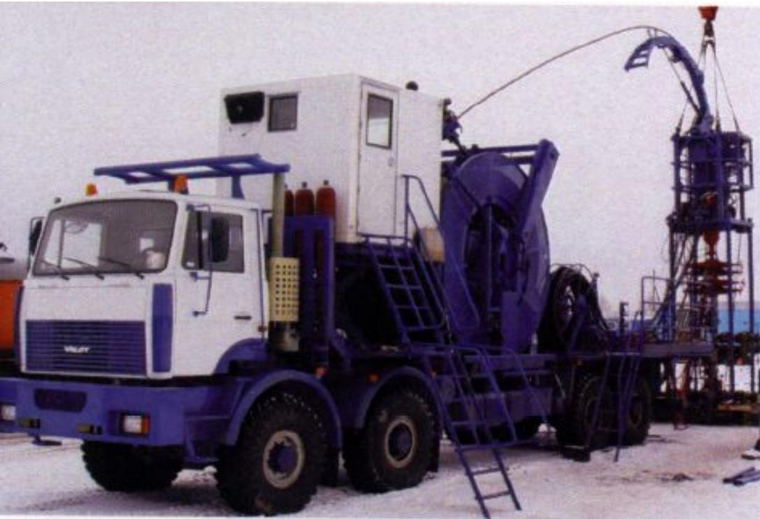
Колтюбинговая установка МК20Т на шасси МЗКТ(8х8) с двигателем ЯМЗ или Caterpillar. Тяговое усилие инжектора до 27 200 кг. 4 200 м. гибкой трубы диаметром 38,1 мм.
