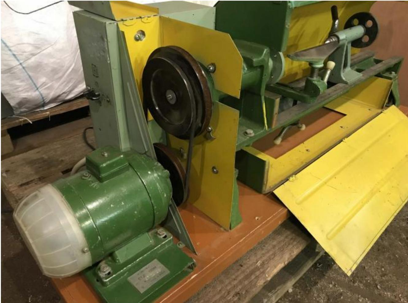
От двигателя с помощью **РЕМЕННОЙ ПЕРЕДАЧИ** передается вращение на **ШПИНДЕЛЬ** передней бабки
