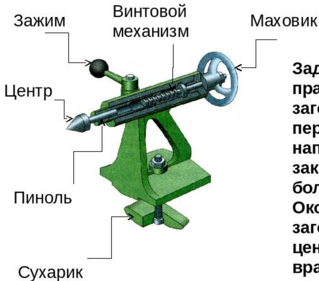
**Задняя бабка служит опорой правого конца длинных заготовок. Она может перемещаться вдоль направляющих станины и закрепляется неподвижно болтом и гайкой. Окончательно конец заготовки поджимают центром. Его перемещают вращением маховика и закрепляют зажимом.**
