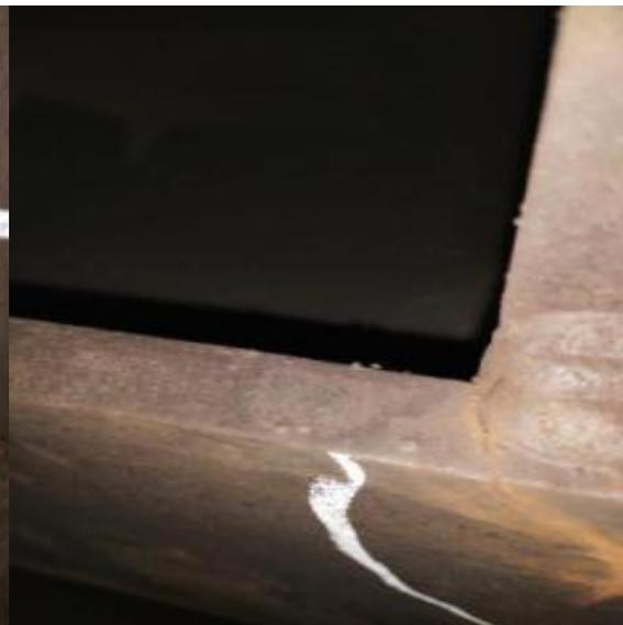
**19-20.11.2019** года на ПТО Дружинино осмотрщиком-ремонтником вагонов **Худяковым Павлом Николаевичем** (стаж с 2014 года), при техническом обслуживании грузового поезда № 1350 у грузеного вагона № 59931790 выявлена трещина, переходящая с горизонтальной на вертикальную полку хребтовой балки длиной 55 мм.
