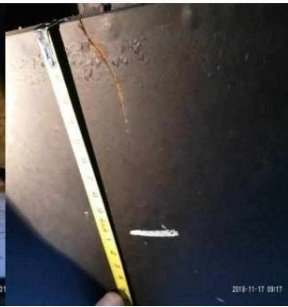
**18.11.2019 года** на ПТО Дружинино осмотрщиком-ремонтником вагонов Брагиным Юрием Александровичем (стаж с 2012 года), при техническом обслуживании грузового поезда № 1072 у грузеного вагона № 54967377 выявлена трещина, переходящая с горизонтальной на вертикальную полку хребтовой балки длиной 70 мм.
