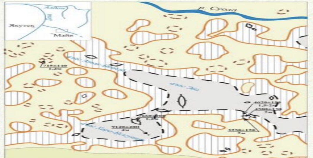
Схема распространения оползневых (термоделяпсивных) образований на днищах термокарстовых котловин аллювиальной равнины среднего течения р. Суола (по Иванову М.С., 1984 г.)
