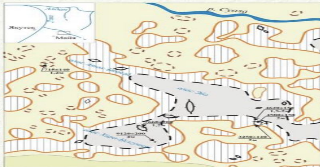
Схема распространения оползневых (термоделяпсивных) образований на днищах термокарстовых котловин аллювиальной равнины среднего течения р. Суола (по Иванову М.С., 1984 г.)
