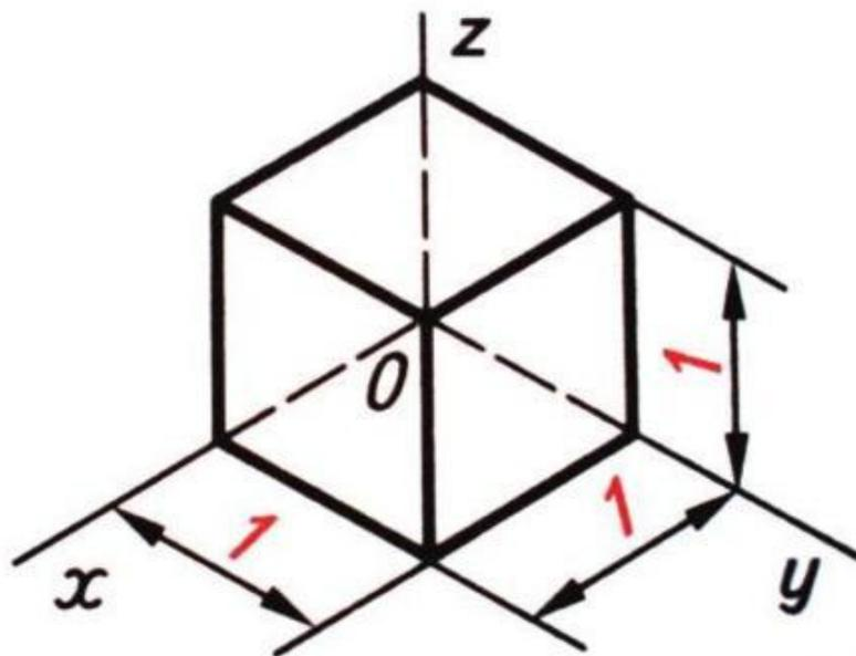
**При построение изометрической проекции**
