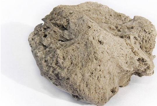
Используется как заполнитель в лёгких бетонах ([пемзобетоне](#)), как гидравлическая добавка к цементам и известям. В качестве [абразивного материала](#) применяется для шлифовки металла и дерева, полировки каменных изделий. Используется также для [гигиенического](#) удаления огрубевшей кожи [стоп](#). В [химической промышленности](#) из пемзы изготавливают [фильтры](#), используют как инертную основу для различных [катализаторов](#).
