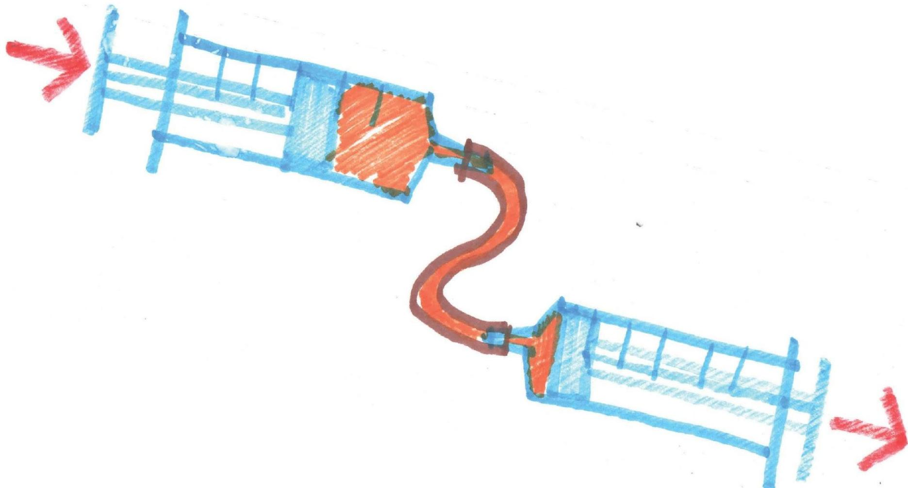
Так же работают **гидроцилиндры на экскаваторе**, только они большие, сделаны из железа и наполнены маслом, а не водой.
