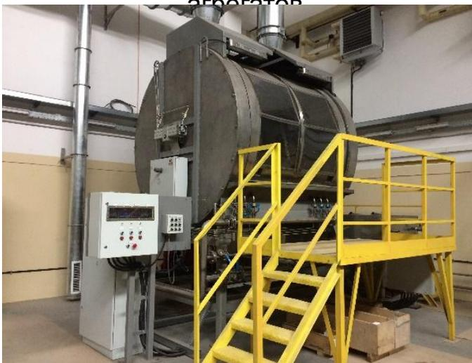
Стенды для эксплуатационных и ресурсных испытаний
