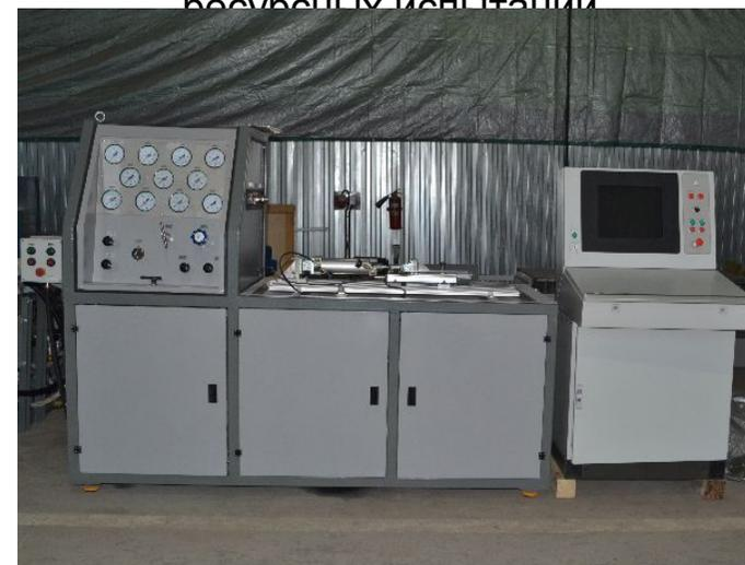
Стенды для испытания масляных систем и агрегатов
