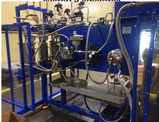
Стенды для испытания пневматических систем
