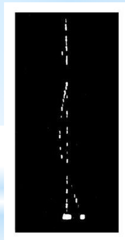
Трек частицы в узкозазорной искровой камере
