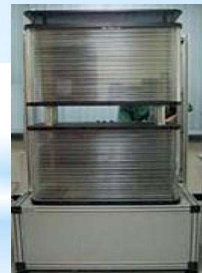
Внешний вид двухсекционной искровой камеры
