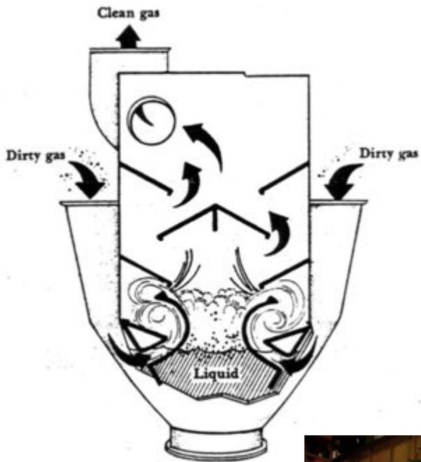
**Скруббер** - устройство, для очистки твёрдых или газообразных сред путём улавливания твёрдых и газовых примесей из газовой смеси, пропускаемой через распылённую жидкость
