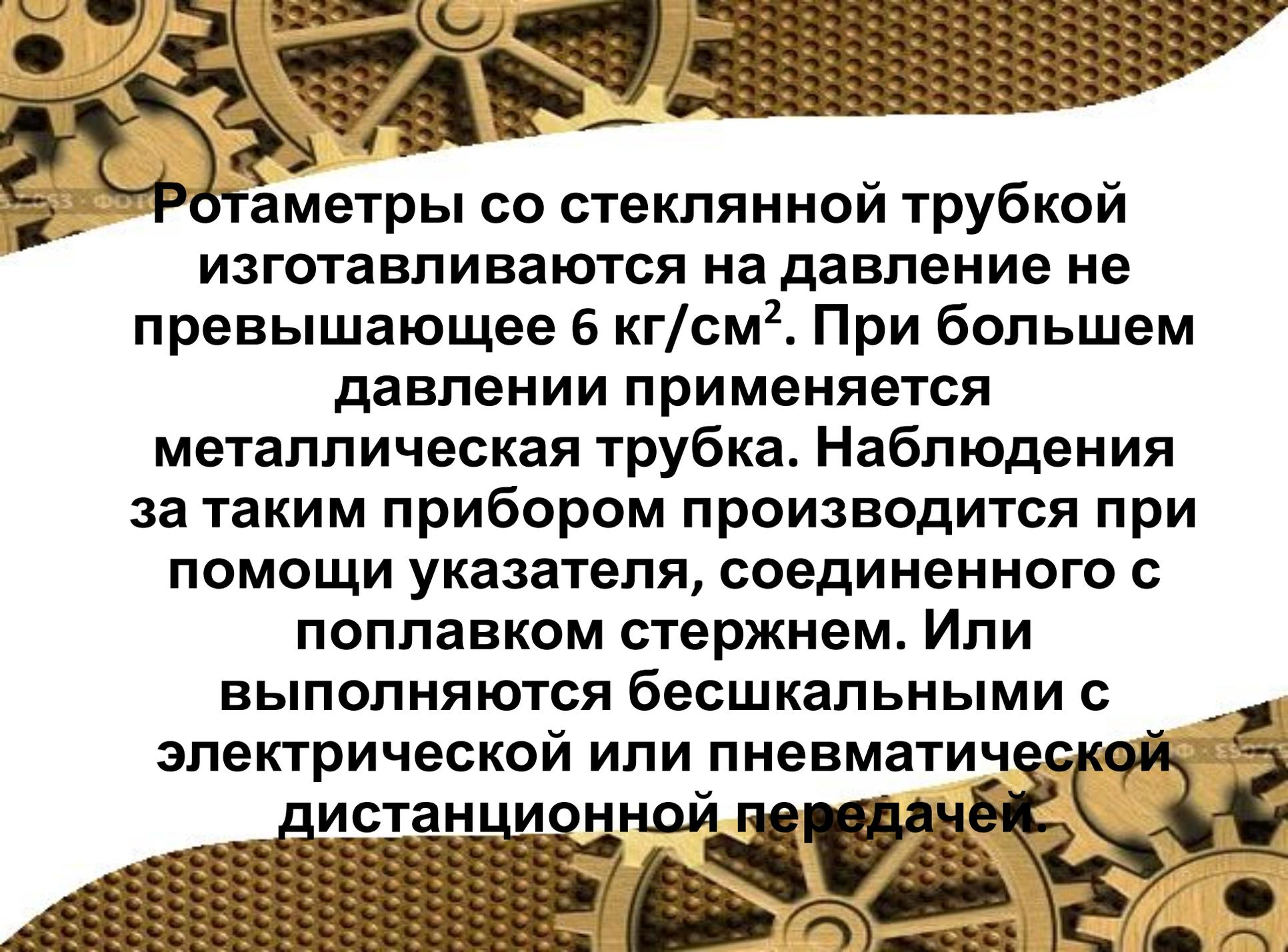
**Ротаметры со стеклянной трубкой изготавливаются на давление не превышающее  $6 \text{ кг/см}^2$ . При большем давлении применяется металлическая трубка. Наблюдения за таким прибором производится при помощи указателя, соединенного с поплавком стержнем. Или выполняются бесшкальными с электрической или пневматической дистанционной передачей.**
