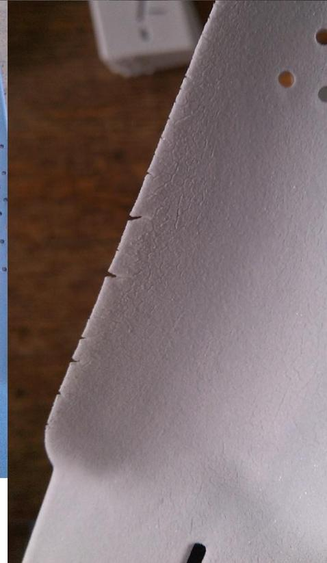
1. Дефекты «сырых» стержней - «незалив», «неспай» и «утяжина» при заполнении пресс-форм сложной конструкции.
