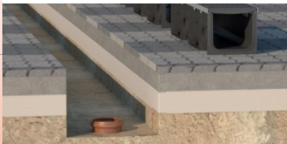
1. Подготовка основания и подключение трубы
