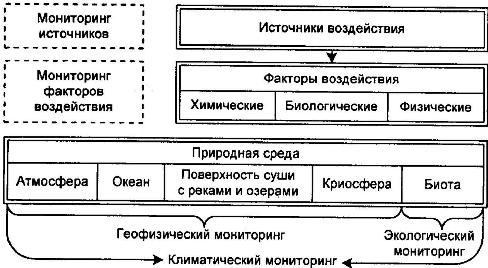
Рис. 2.2. Блок-схема системы мониторинга
