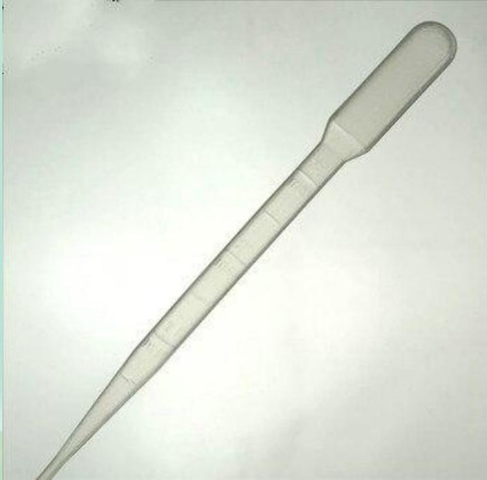
**Пипётка** — мерный или дозирующий сосуд представляющий собой трубку, либо ёмкость с трубкой, имеющую конец (наконечник, кончик, носик) с небольшим отверстием, для ограничения скорости вытекания жидкости.
