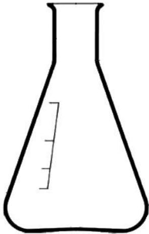
Колба — один из основных видов лабораторной посуды, емкость, с довольно длинным и узким по отношению к корпусу, горлом. Обычно колбы лабораторные — стеклянные, хотя изредка применяются и пластиковые.
