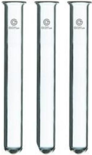
**Пробирка** — специализированный сосуд цилиндрической формы, имеющий полукруглое, коническое или плоское дно.
