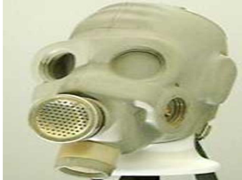
**Противогазовая коробка** (фильтрующе - поглощающая коробка) предназначена для очистки вдыхаемого воздуха от аэрозолей и паров ОВ, РВ, БА. Противоаэрозольный (противодымный) фильтр, затем специальный поглотитель (шихта), созданный на основе активированного угля с различными химическими добавками.
