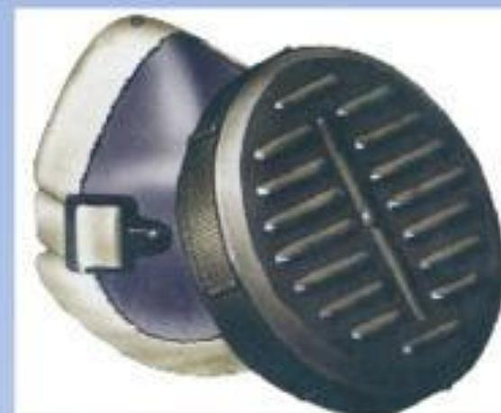
Респиратор многократного использования со сменным фильтром. Защищает от силикатной, металлургической, горнорудной, угольной, табачной пыли, пыли порошкообразных удобрений и нитроксида, не выделяющих токсических газов. Широко применяется шахтёрами при высокой запылённости ( $500 \text{ мг/м}^3$  и более). Масса — 250 г.
