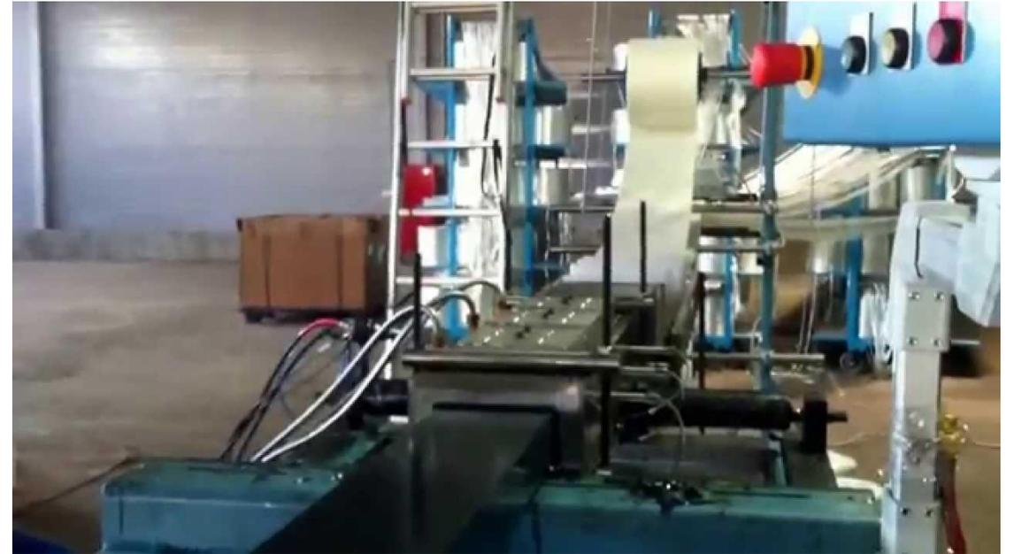
Конечный продукт, выходящий из фильеры - это сильно отвержденный продукт, не требующий обработки. Отвержденный продукт вытягивается из фильеры вытяжной машиной и в отрезной машине распиливается на готовые к использованию сегменты.
