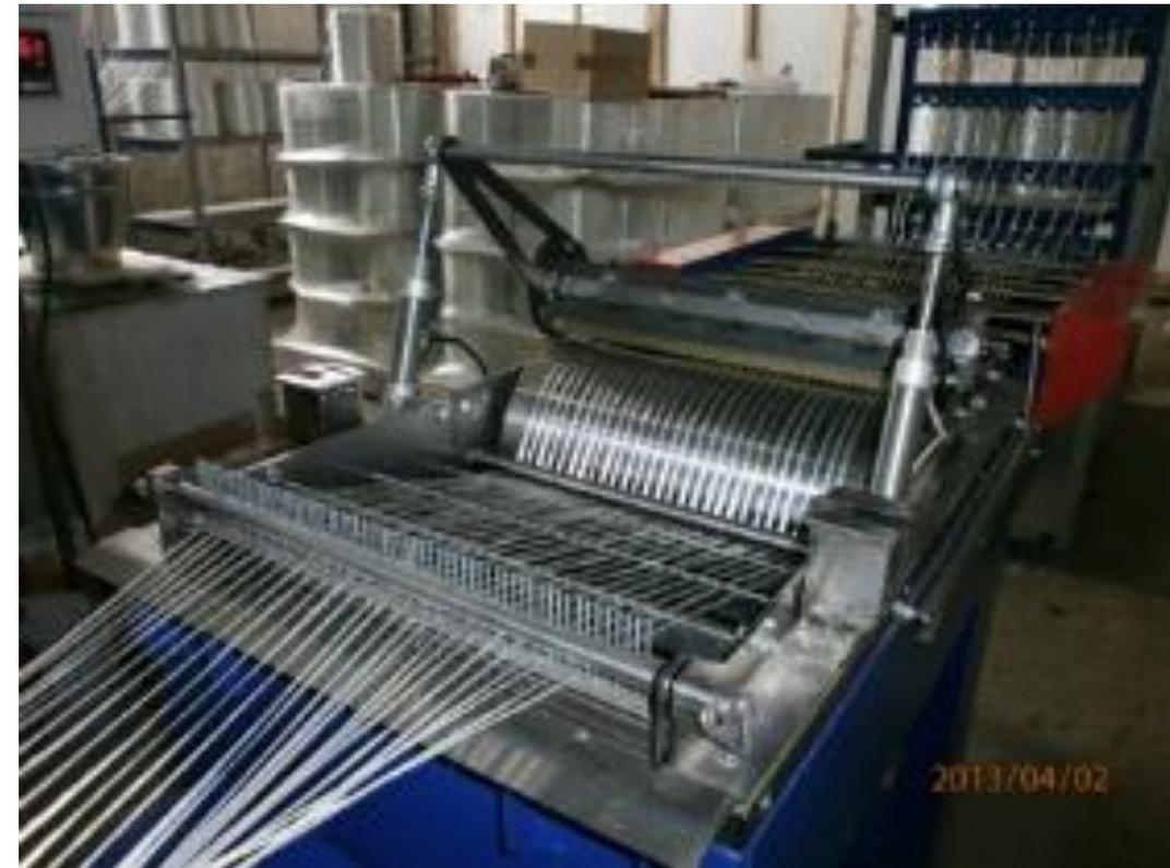
Затем пропитанные полимером волокна пропускаются через преформовочное устройство, которое придает волоконно-полимерному составу желаемую форму и выравнивает волокна.
