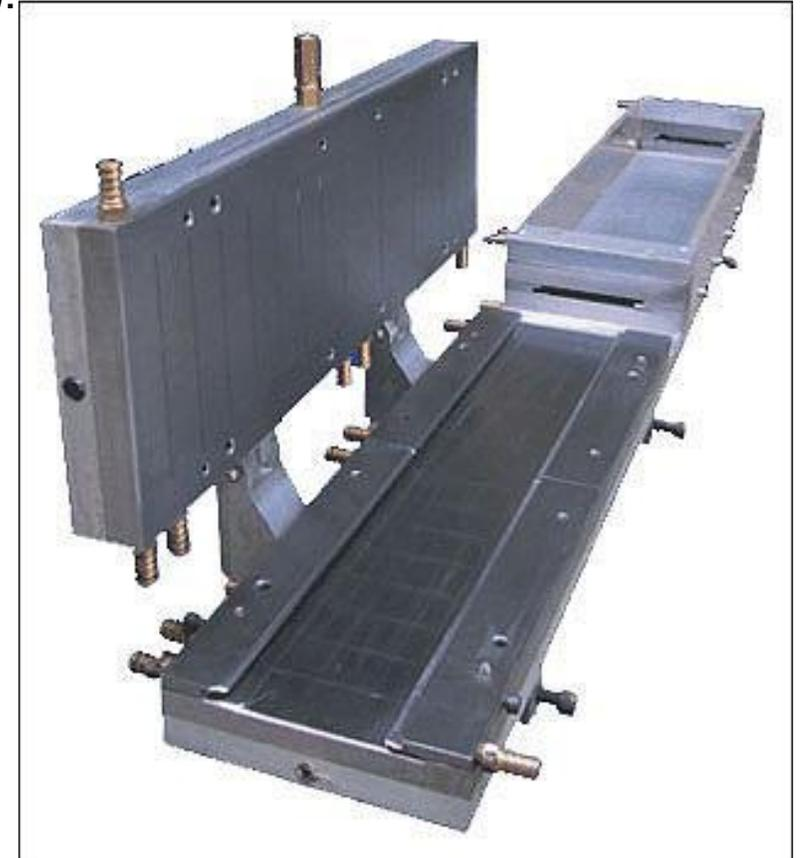
Несколько комплектов нагревателей, находящихся в прямом контакте с фильерой, создают несколько зон нагрева (обычно 4...6), и обеспечивают оптимальные для процесса полимеризации температурный профиль. Температурный профиль задает система управления в зависимости от изделия и скорости протяжки. Как и в процессе экструзии, во время пултрузии возникают эффекты саморазогрева (экзотермическая реакция в полимере).
