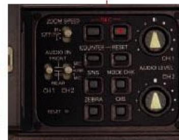
Панель управления за ЖК-экраном. Регулировка уровня записи звука
