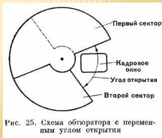
Рис. 25. Схема обтюратора с переменным углом открытия
