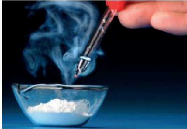
1-сурет. Кальций оксидінің сумен жылу бөліп әрекеттесу реакциясы
