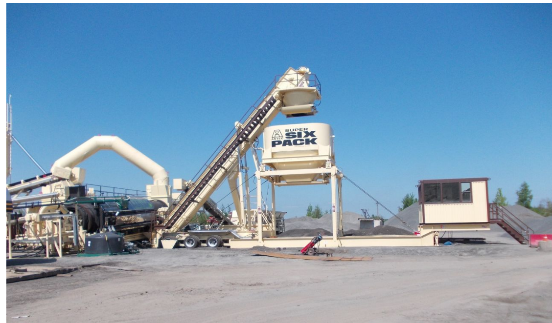
Применение высококомобильных АБЗ с добавлением асфальтогранулята с 2003 года
