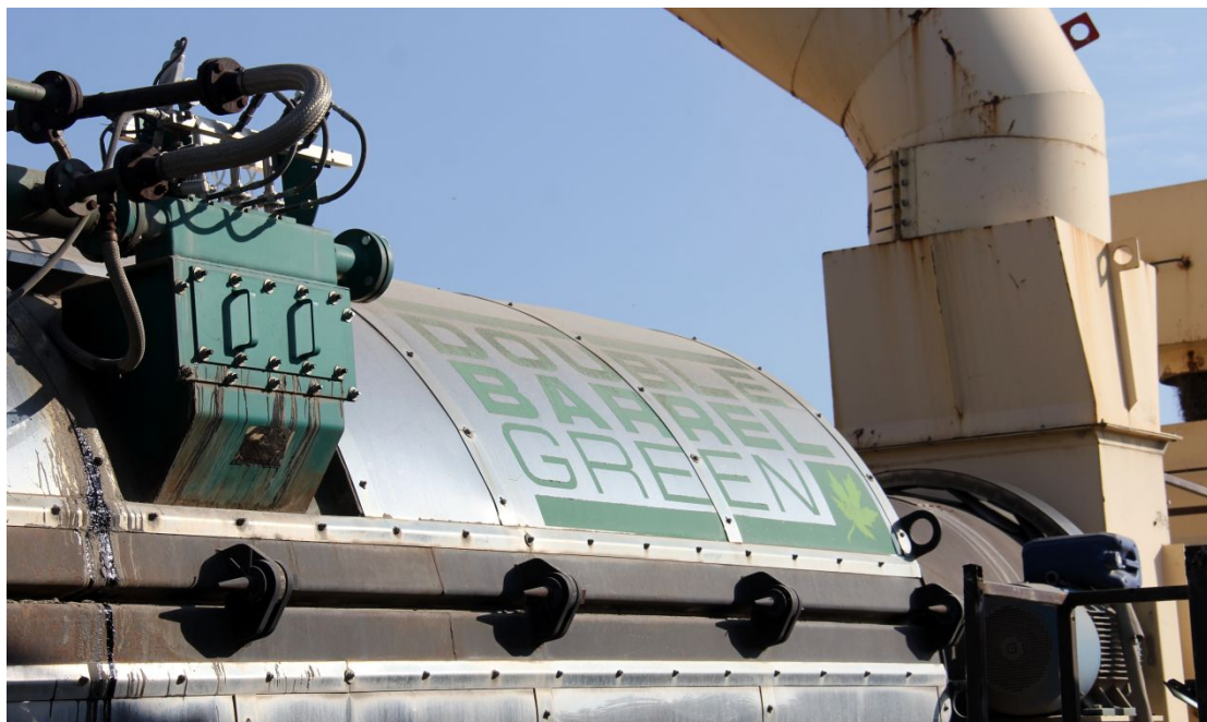
Применение технологии теплых асфальтобетонов с 2012 года
