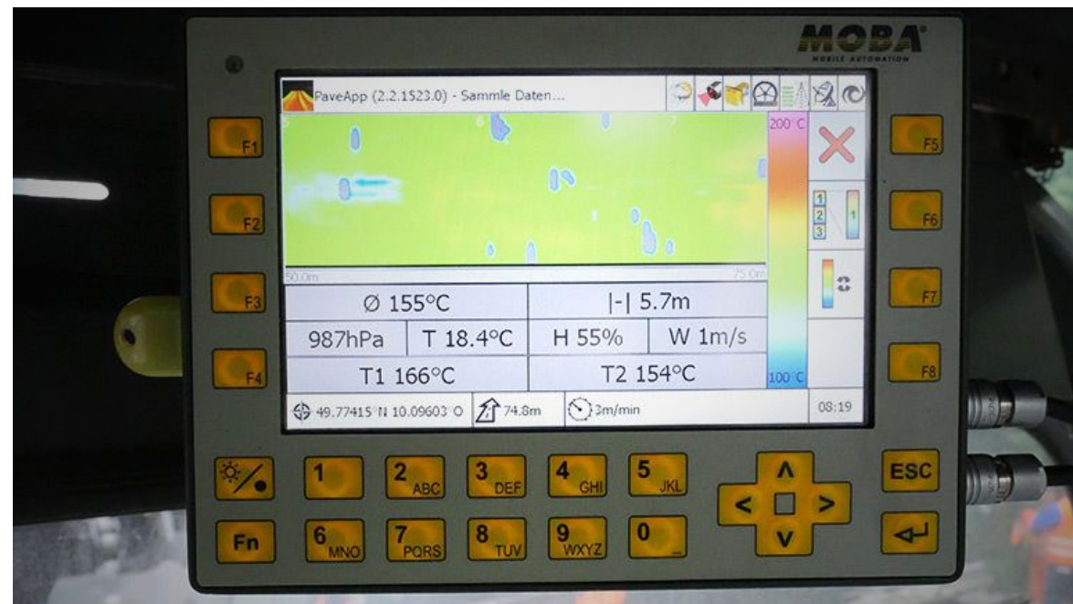
Применение инфракрасных лыжи/сканера для определения температурной сегрегации с 2012 года
