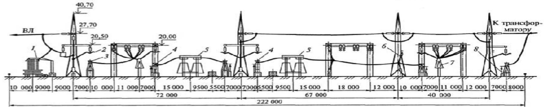
Рис. 6.15. ОРУ 500 кВ по схеме 4/3 выключателя на присоединение. Разрез по ячейке линии и трансформатора:
