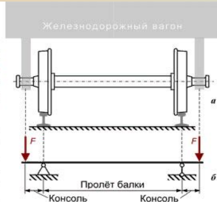
Рис. 1.2. Пример реальной конструкции (а) и соответствующей ей расчётной схемы (б)
