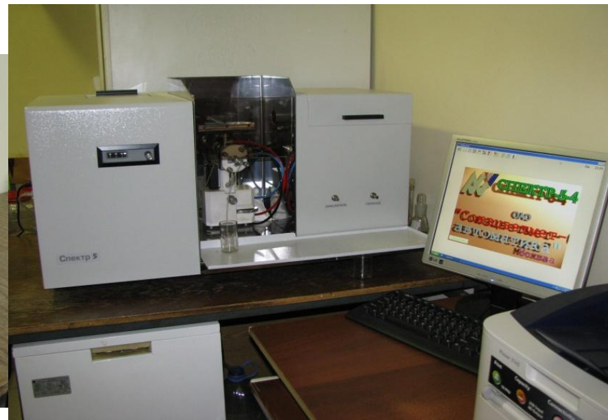
Концентратор БК-01, соединенный с ААС «Спектр-5-4»
