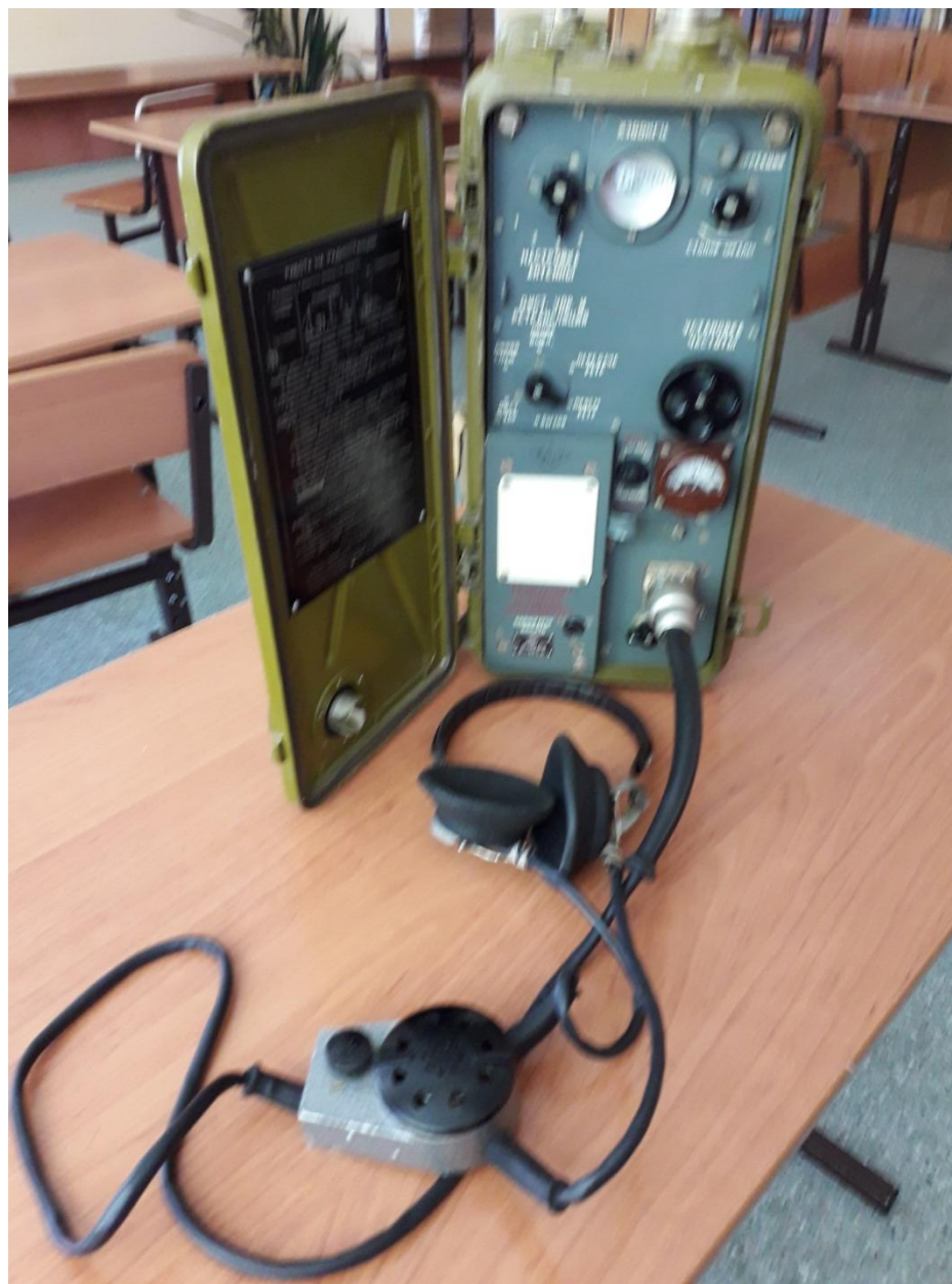
Советская переносная ультракоротк оволновая радиостанция военного назначения
