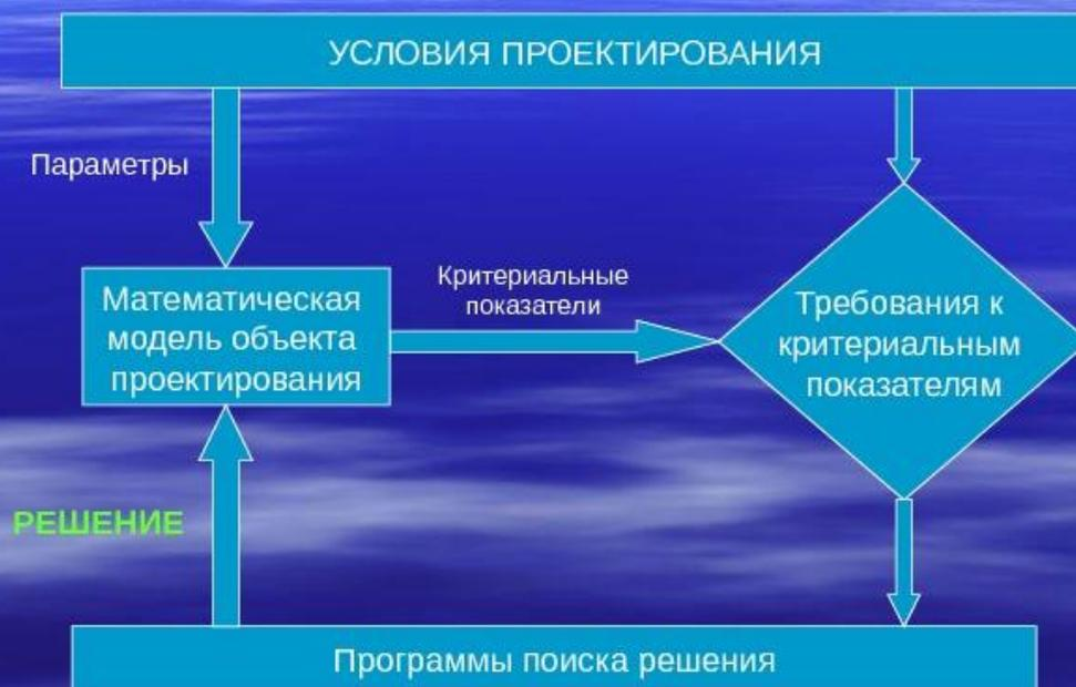
Программы расчета технических параметров основаны на расчетных методах, реализуют вычислительный алгоритм, который по входным параметрам и требованиям к объекту проектирования выдает числовые значения искомых параметров.
