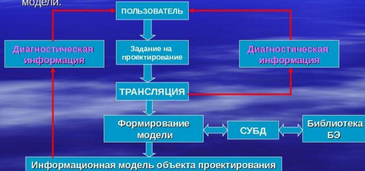
Число циклов проектирования зависит от уровня автоматизации проектных работ. При автоматизированных методах с использованием математической модели для анализа решений число этих циклов может быть самым различным и существенно зависит от уровня компетенции пользователя.
