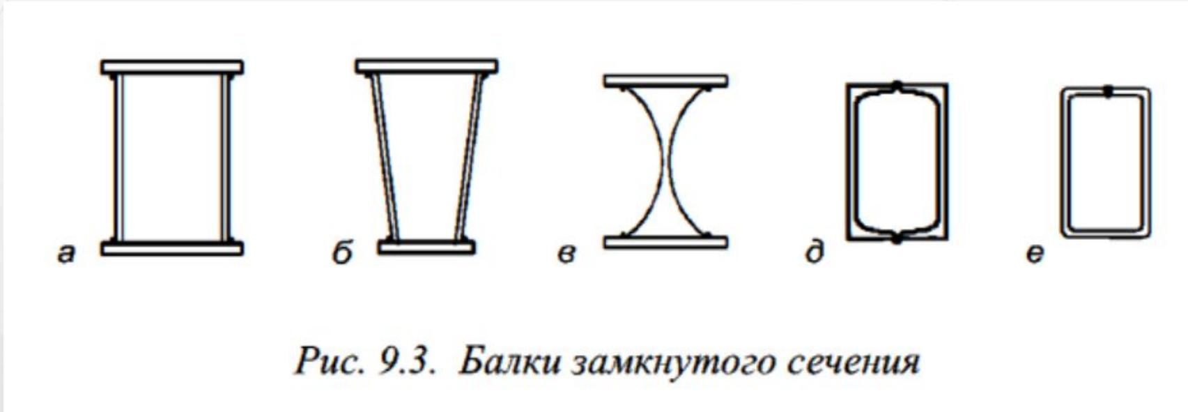
*Рис. 9.3. Балки замкнутого сечения*
