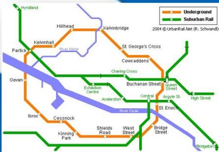
Строительство метрополитена Глазго началось в 1880-х. 14 декабря 1896 года пусковой участок длиной 10.4 км и состоящий из 15 станций, был торжественно открыт. Диаметр туннелей метрополитена Глазго очень мал: примерно 3.35 метра. На сегодняшний день метрополитен Глазго – это кольцевая линия, содержащая 15 станций.
