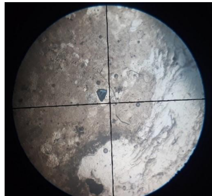
Шлиф образца №3. Голубой кристалл флюорита в риолите ( d_{пз} -1,85 мм, николи параллельны).
