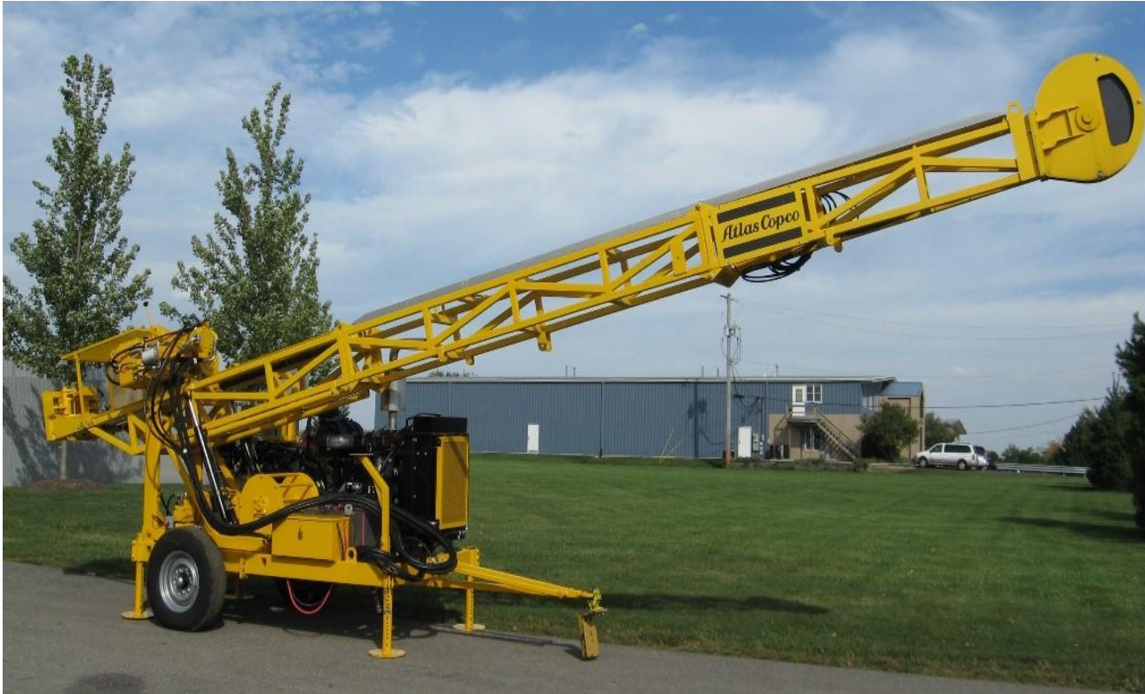
Atlas Copco Christensen CS1000 P4 (для бурения средних и глубоких скважин).
