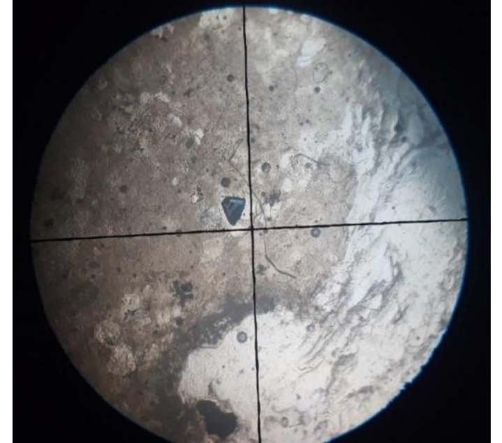
Шлиф образца №3. Голубой кристалл флюорита в риолите ( d_{пз} -1,85 мм, николи параллельны).
