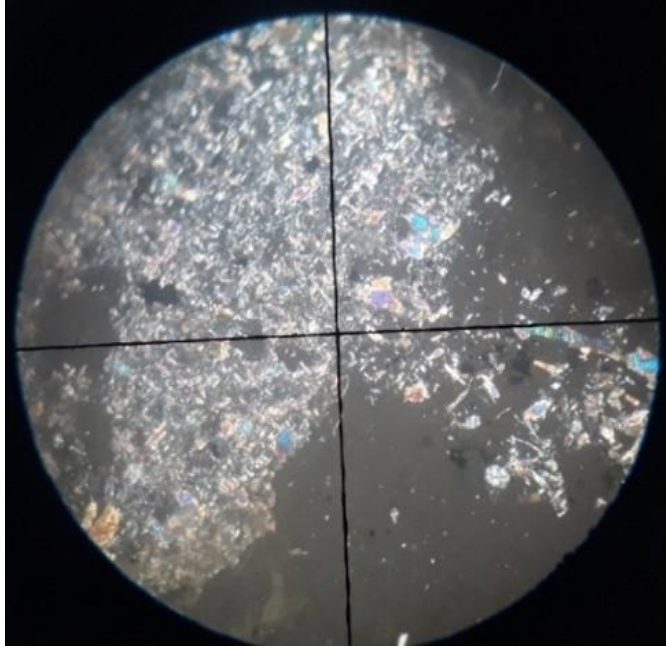
Шлиф образца №2. Кристаллы альбита и пироксенов в общей стекловатой массе гидротермально измененного риолита (dпз - 5,4 мм, николи скрещены).
