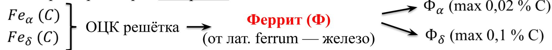
В феррите растворено очень мало углерода, эта фаза «практически чистое железо», а значит по свойствам близка к нему (предел прочности  $\sigma_B = 300 \text{ МПа}$ ; пластичность  $\delta = 40 \%$ ; твёрдость  $80 \text{ НВ}$ ), т.е. феррит – очень мягкая и пластичная фаза.
