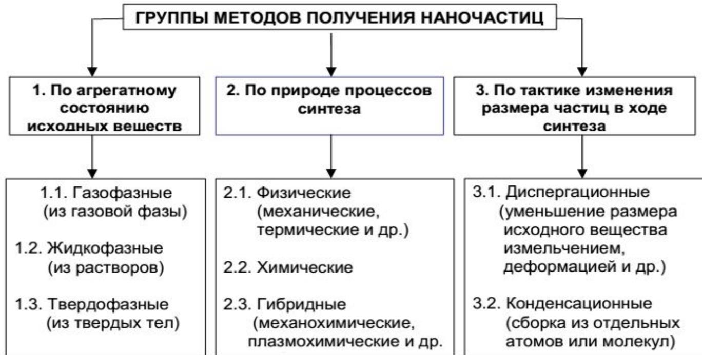
Рис.1. Упрощенная классификация методов получения наночастиц
