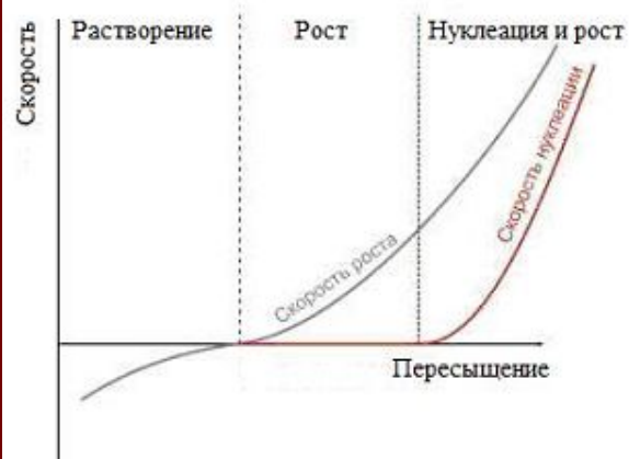
Рис. 3. Зависимость скорости зародышеобразования и скорости роста фазы
