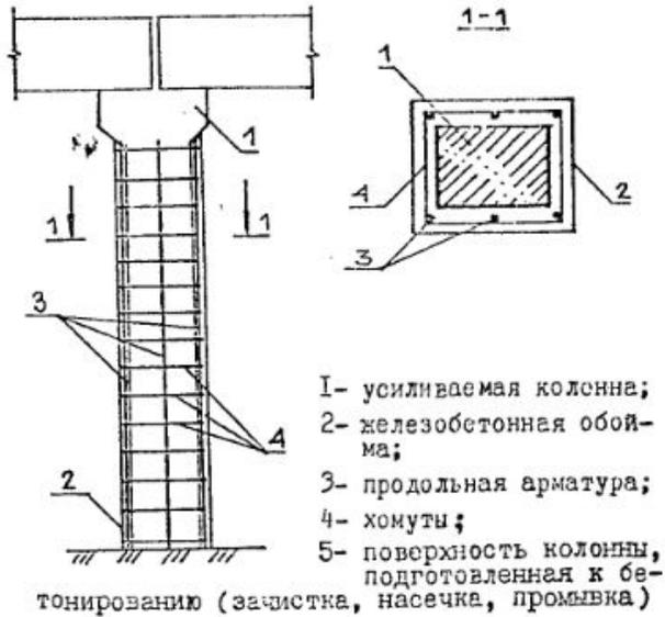
УСТРОЙСТВО ЖЕЛЕЗОБЕТОННОЙ РУБАШКИ
