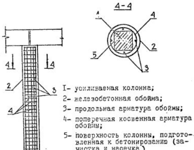
УСТРОЙСТВО ЖЕЛЕЗОБЕТОННОЙ ОБОЙМЫ С КОСВЕННЫМ АРМИРОВАНИЕМ
