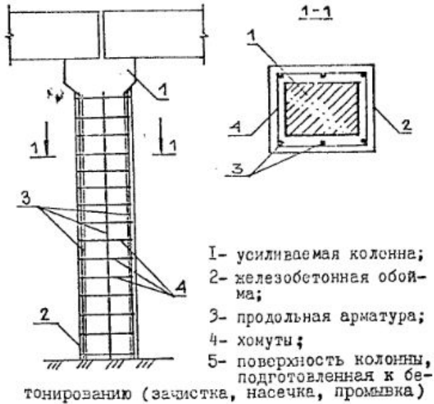
УСТРОЙСТВО ЖЕЛЕЗОБЕТОННОЙ ОБОЙМЫ С КОСВЕННЫМ АРМИРОВАНИЕМ
