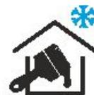
Нанесение при t до -20°C
