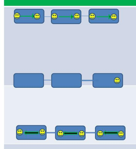
Следует к хвостовой кабине. В каждом вагоне проверяет величину давления в ТЦ, (2,5-2,7 атм головных ДЛЯ вагонов И 2,4-2,6 ДЛЯ промежуточных) качество уборки салонов, крепление диванов, положение кранов дверей, сцепа выключения правильность между вагонами, положение концевых кранов. В каждом вагоне проверяет напряжение на АКБ, состояние огнетушителей. В хвостовой кабине включает АКБ, автоматы А-53 и А-49. Проверяет работу поездной радиосвязи
