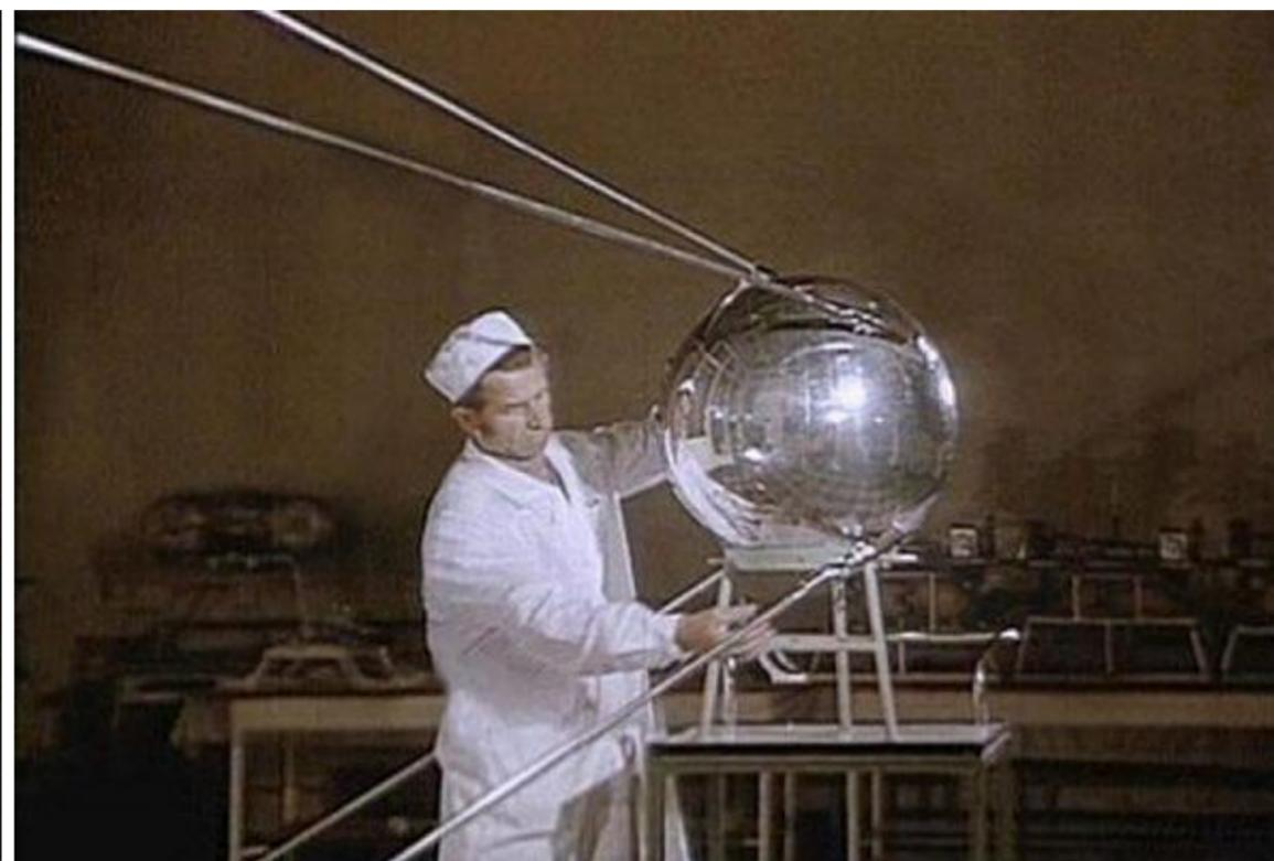
*Внутри герметичного корпуса были размещены: блок электрохимических источников (серебряно-цинковые аккумуляторы массой около 50 кг); радиопередающее устройство; вентилятор; термореле и воздуховод системы терморегулирования; коммутирующее устройство бортовой электроавтоматики; датчики температуры и давления; бортовая кабельная сеть. Масса — 83,6 кг.*
