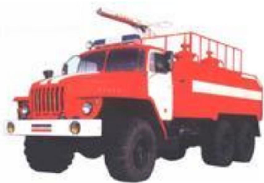
Средние АКТ работают на сочетании порошковых установок и водопенных насосного типа.
