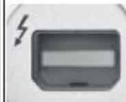
**Thunderbolt** - интерфейс для подключения периферийных устройств. Позволяет достичь скорости до 10 Гб/с на расстоянии до 3 м, при использовании медного кабеля. На текущий момент один из самых быстрых интерфейсов, позиционируемый как замена USB, IEEE1394, DVI, eSATA.
